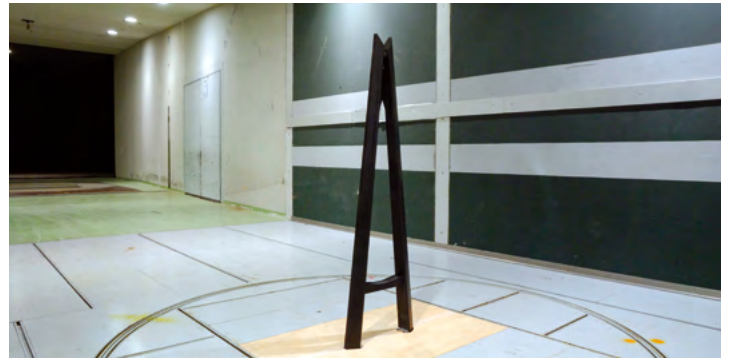
> Dimensionnement au vent d'un pylône dans la soufflerie Jules Verne.
