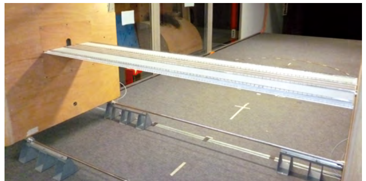
> Essai sur un tablier dynamique dans la soufflerie atmosphérique.
